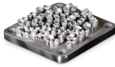
LaserForm CoCr (C) を使用した歯科用パーシャル、コーピング、ブリッジ
